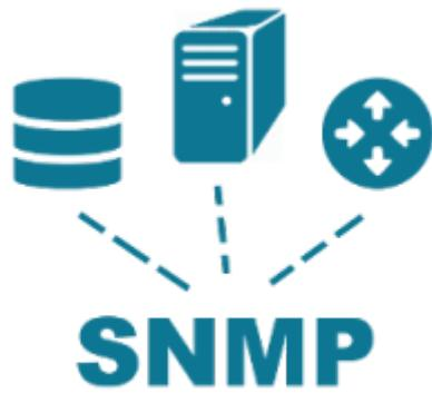
Le protocole SNMP permet à une application de gestion de demander des informations provenant d'une unité gérée. L'unité gérée contient un logiciel qui envoie et reçoit des informations SNMP. Ce module logiciel est généralement appelé agent SNMP. Cet exportateur est le moyen recommandé pour exposer les données SNMP dans un format que Prometheus peut intégrer.
