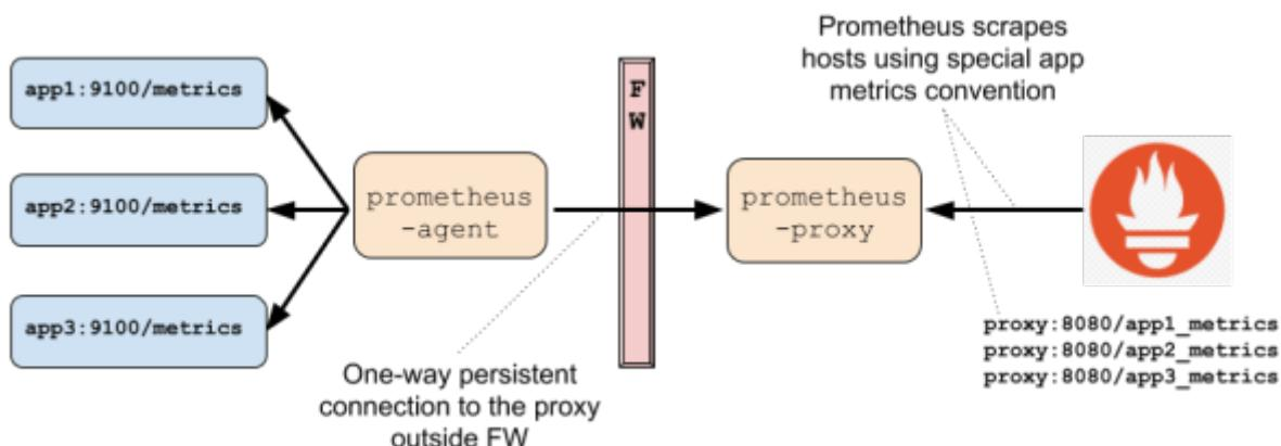
Pour superviser une infrastructure complexe qui comporte plusieurs niveaux d'isolations, le mode *Pull* devient problématique. Au lieu d'utiliser le mode *Push* qui vient à l'esprit naturellement, Prometheus fourni un *proxy* permettant de conserver le modèle *Pull*, et de superviser tous les systèmes derrières le(s) *Firewall(s)*.
